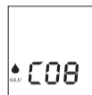
2、显示GLU字符，表示血糖试条，滴血标志闪烁，可以吸入血样。
